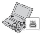
Al poco tiempo, el tiempo de reproducción restante aproximado y la información de la batería se muestran durante unos 7 segundos. Si vuelve a presionar el botón DISPLAY/BATT INFO mientras la información está en pantalla, ésta permanecerá visible hasta 20 segundos. Carga restante de la batería (aprox.)
